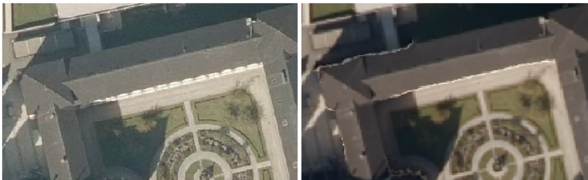
Abbildung 26: Gegenüberstellung eines Gebäudebereichs des Stifts Admont: Orthofoto aus der Orthofotokooperation (links, 0,2 m Auflösung) und selbst erstelltes True-Orthomosaik (rechts, 0,5 m Auflösung)
