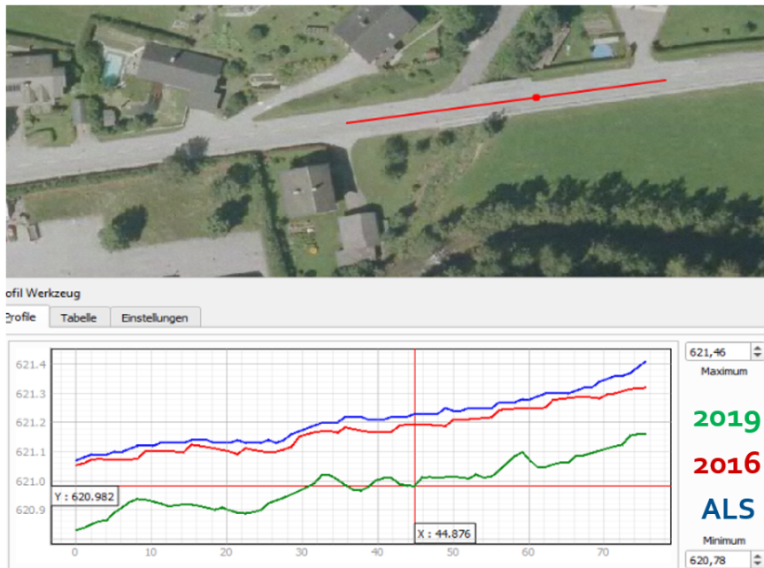
Abbildung 21: Höhenversatz 2016 und 2019 Straßenlängsschnitt
